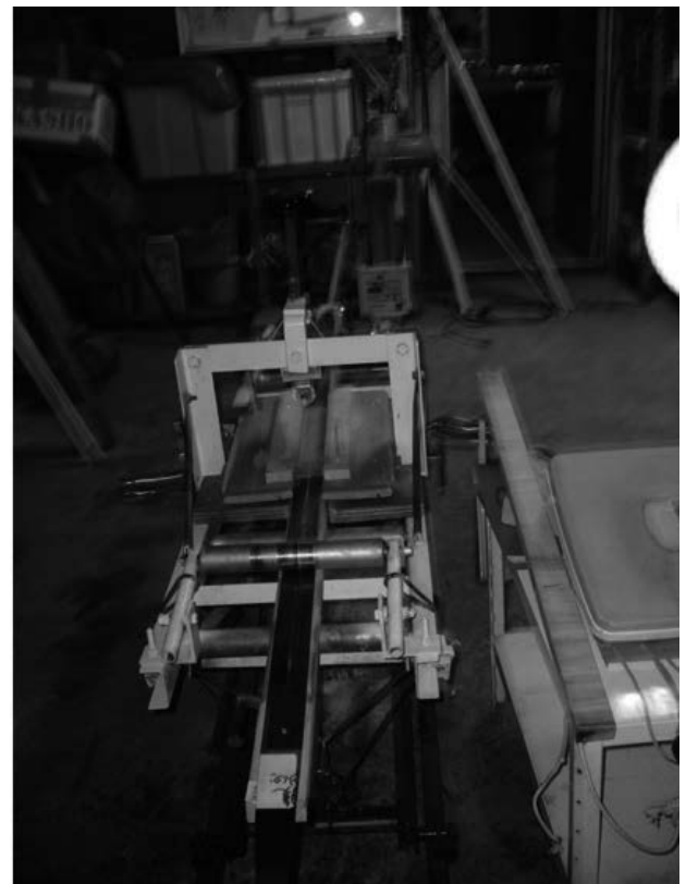
写真 1 スキー滑走面の鮫鱗皮グリップゾーンの擦動装置 奥にモータ、ゾーン（鉄棒下）面を加圧角材が擦動する。
